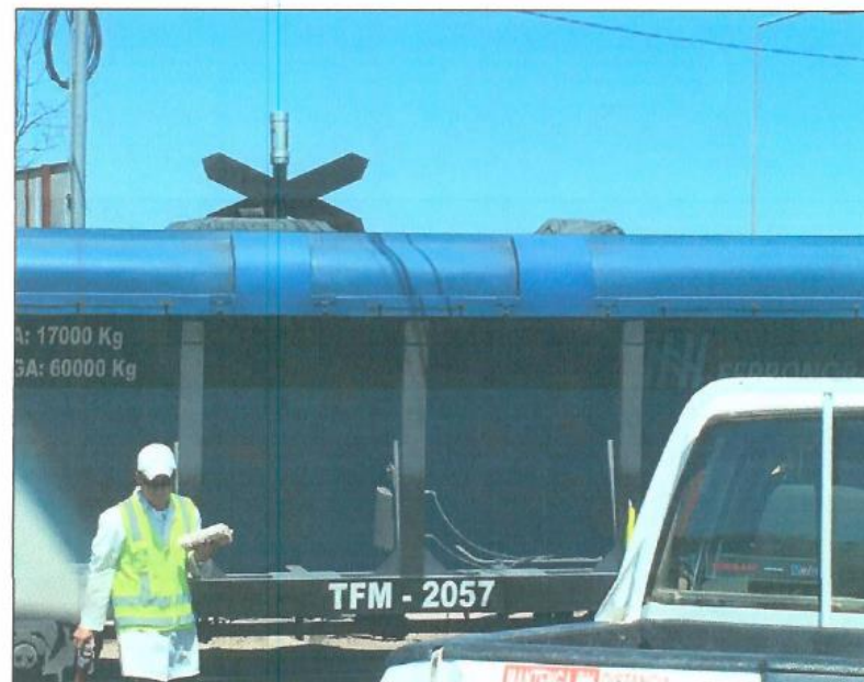
Figura N°5. Carro TFM-2057 cargado con minerales superando la altura de la cúpula de fibra de vidrio.
