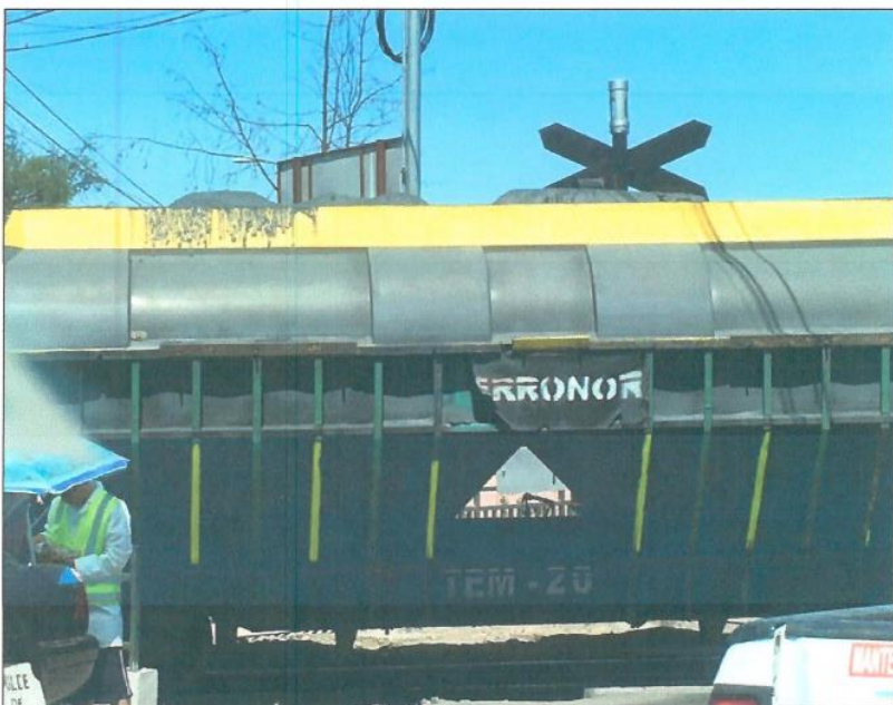
Figura N°4. Se observa carga expuesta a la acción del viento debido a que supera la altura de la cúpula de fibra de vidrio.
