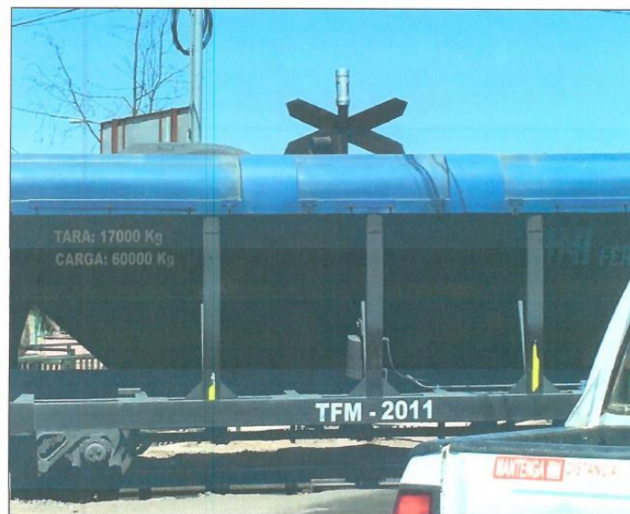
Figura N°3. Carro identificado como TFM-2011 se aprecia carga que supera la altura de la cúpula.
