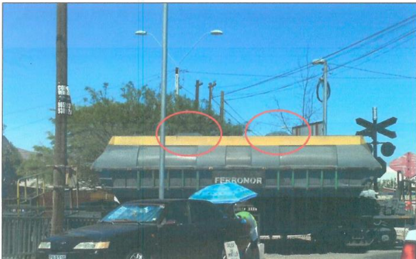
Figura N°2. Se observa que la carga del carro supera la altura de la cúpula de vidrio, quedando expuesta a la acción del viento durante todo el transporte.
