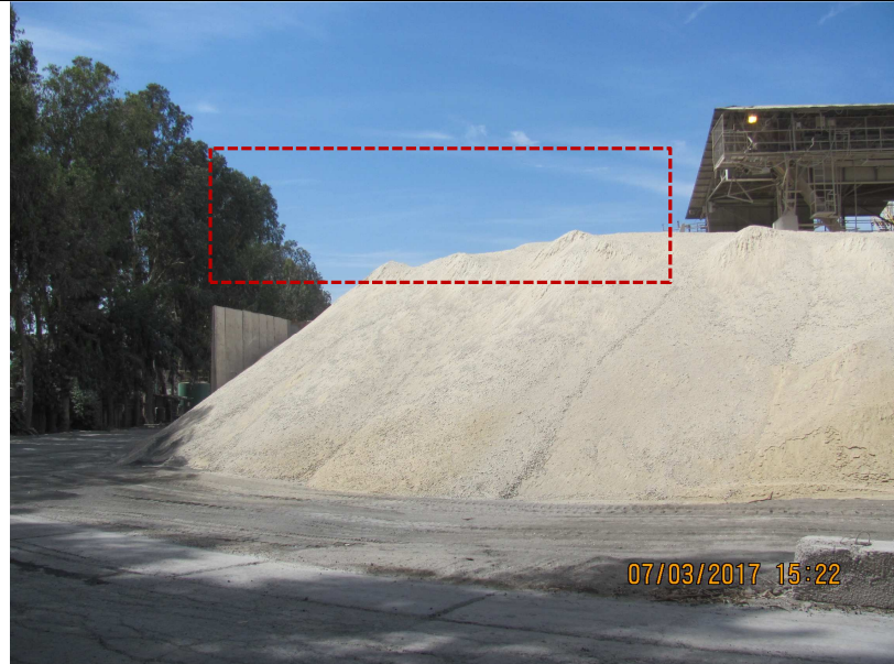
Fotografía 10 Fecha: 3 de agosto de 2016 Coordenadas WGS84, Huso 19 Norte: 6.369.863 m. Este: 293.996 m Descripción medio de prueba: En la imagen se aprecia que la altura de la pila de la conchuela almacenada excede la altura de las paredes de hormigón, en el área no techado del extremo poniente del sector norte cancha nave grúas puente.
