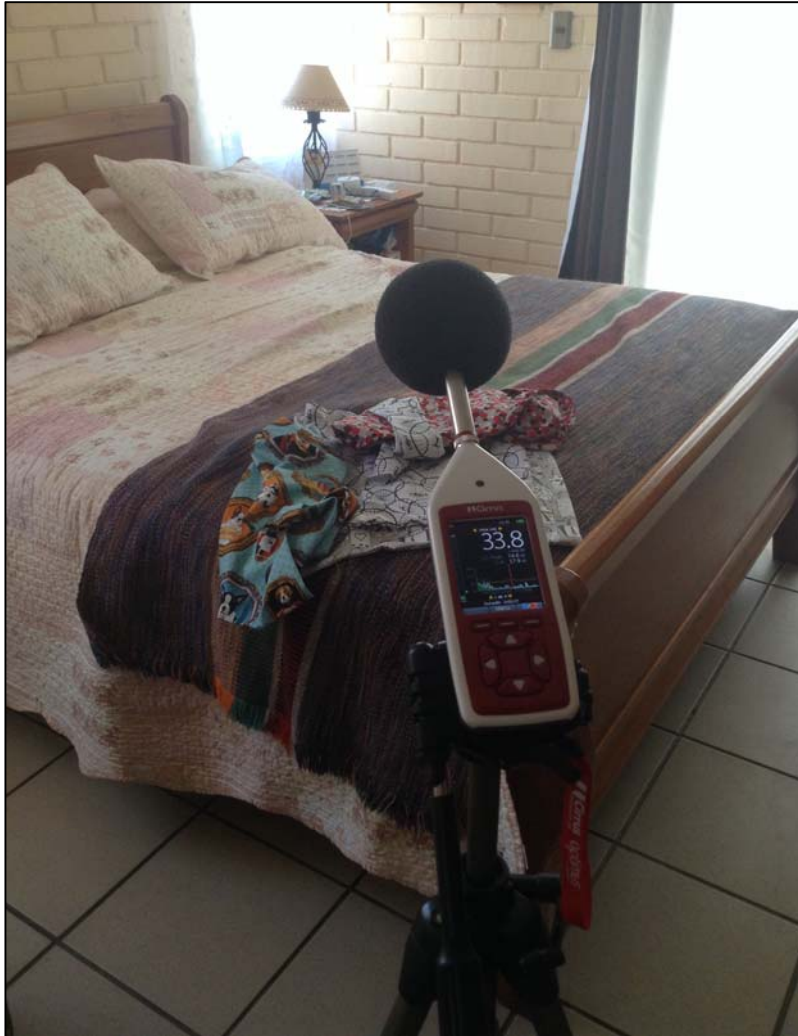
Fotografía 1: Vista al interior dormitorio principal, durante medición de ruido de fondo.
