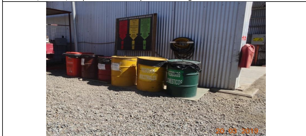
Fotografía 36. Fecha: 20-03-2019 Coordenadas UTM DATUM WGS84 HUSO 19 S Norte: 6.763.470 Este: 298.997 Descripción del medio de prueba: A un costado del área de almacenamiento de aceites usados del área de mantenimiento, se observa área de segregación de residuos con tambores metálicos de colores.
