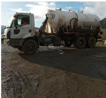
Camión Marca Ford Amplirol con un Tanque Autónomo de Capacidad de Estanque de 10m3
