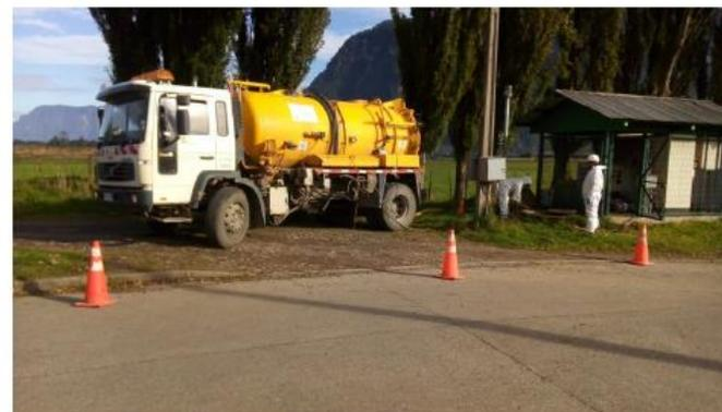
Camión Marca Volvo Capacidad de Estanque de 6m3
