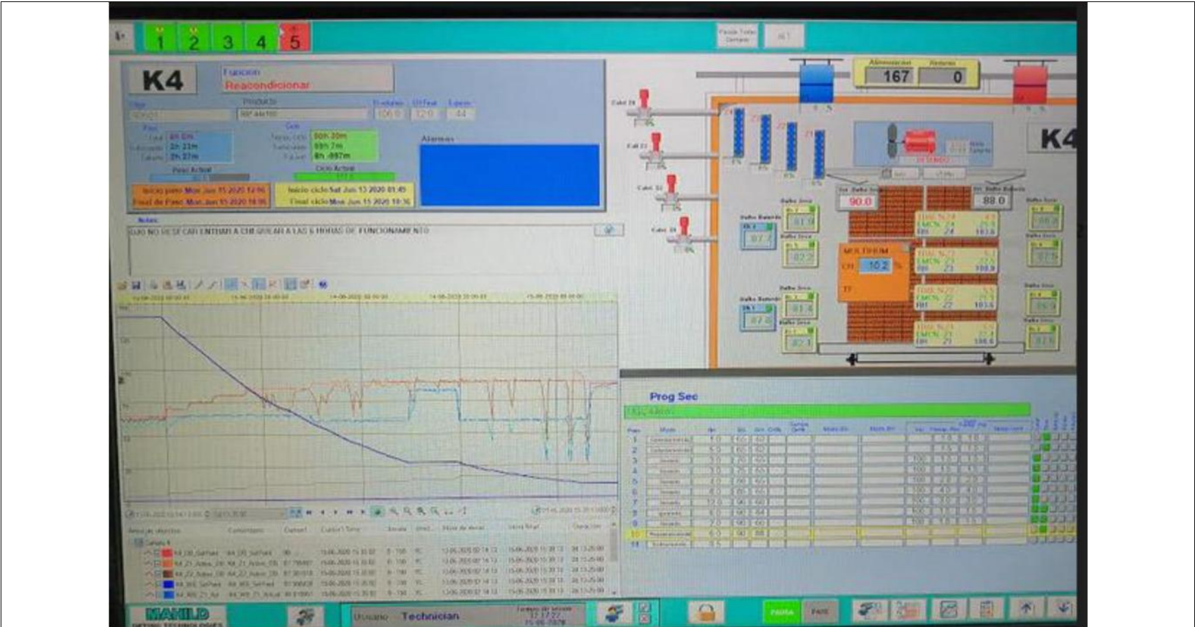
Figura N°1 Fecha: 17.06.2020 Descripción: Sistema de control que acredita la detención de secadores / Reporte tiempos de detención.
