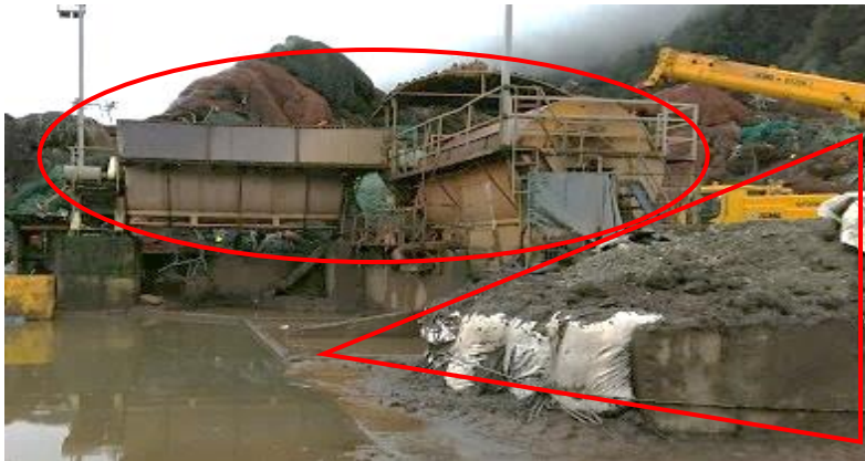
Fotografía N°17 | Fecha: 11-08-2020 Descripción del medio de prueba: Círculo rojo lavadoras de redes, sin funcionamiento. Triángulo rojo filtro primario colmatado con residuos sólidos (Choritos y pelillo)
