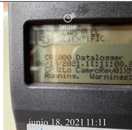
Fotografía 16 Datalogger de SO 2 en estación Lo Campo
