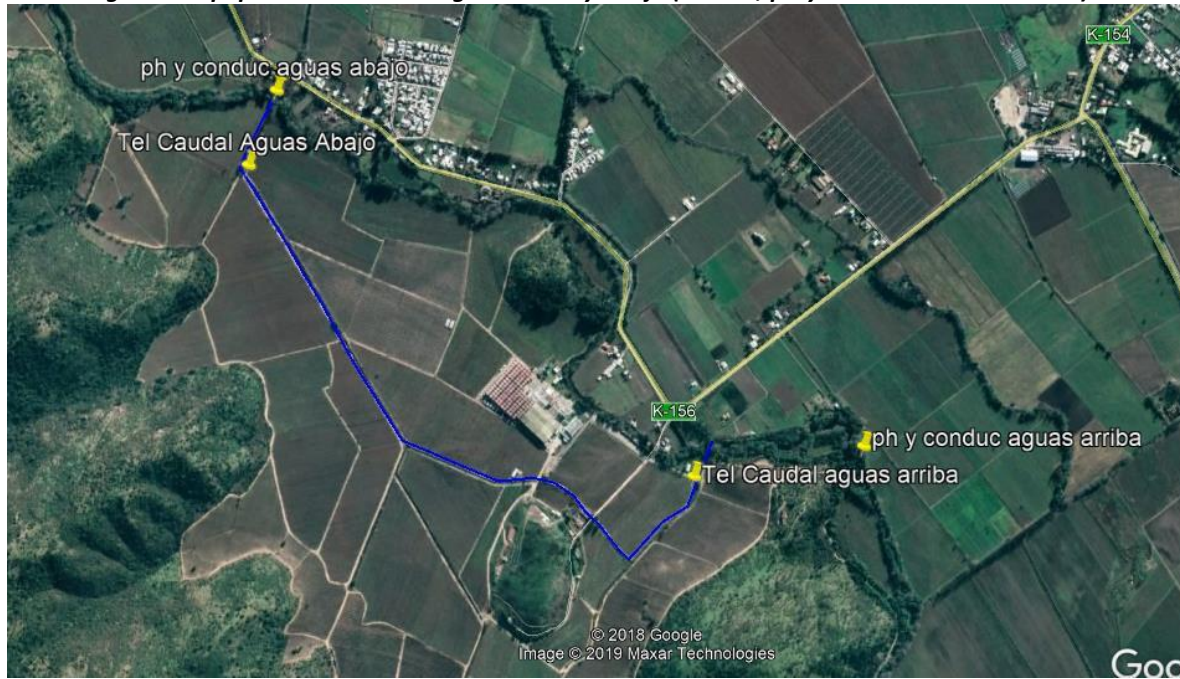
Figura 5: Equipos de telemetría aguas arriba y abajo (Caudal, pH y conductividad eléctrica)
