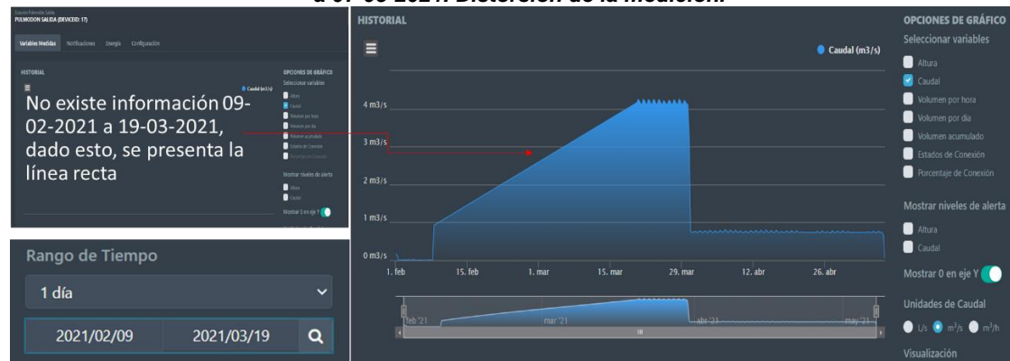
Figura 2: Grafico de m 3 /s, Aguas abajo Pulmodón, registro de cambio de aforo 01-02-2021 a 07-05-2021. Distorsión de la medición.
