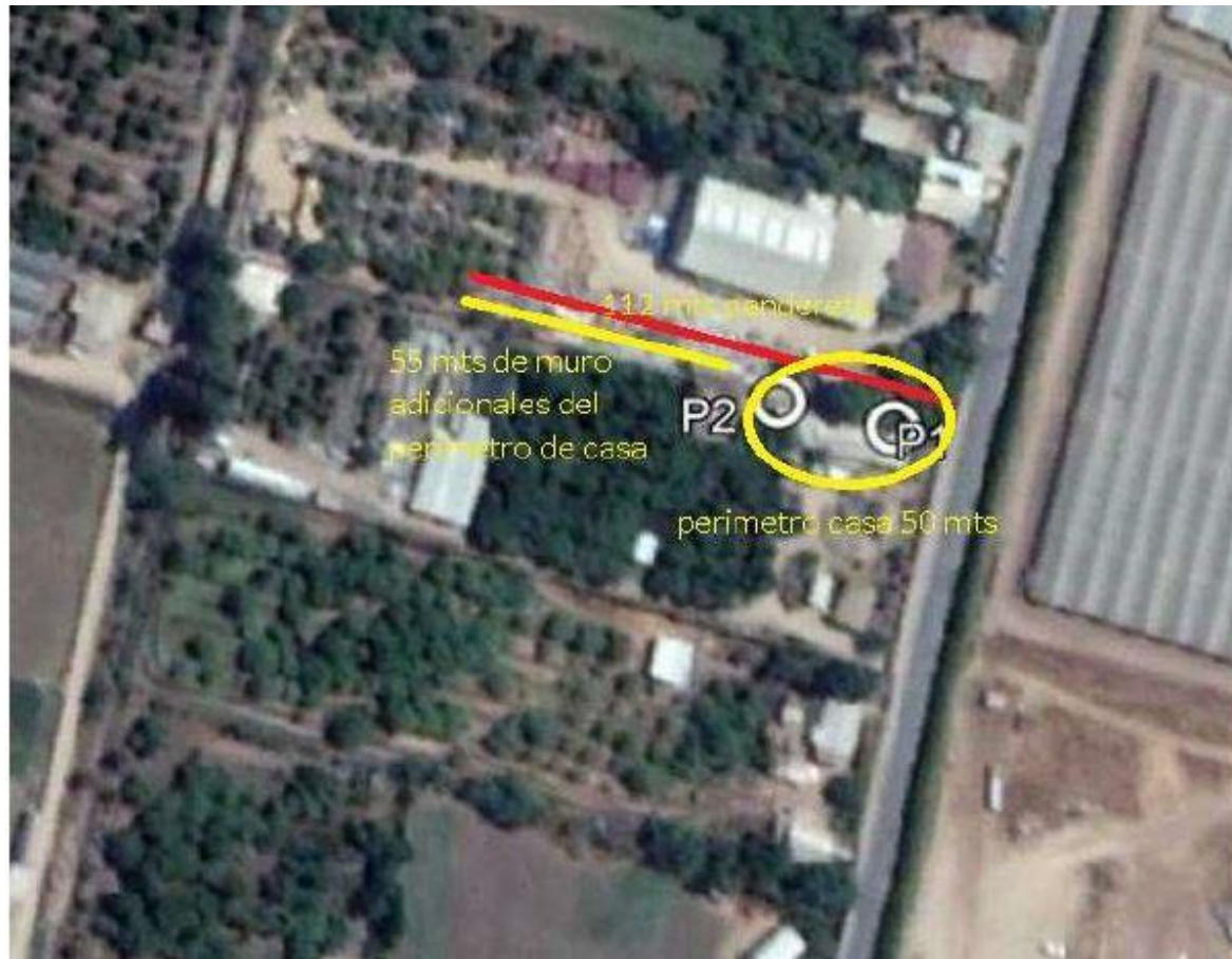
Figura N°2: Nueva longitud de 112 m de barrera acústica (doble pandereta con revestimiento de espuma), propuesto como acción N°5 y ubicación de receptores.
