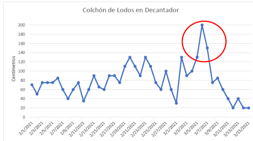
Figura. 11 Fuente: Aconcagua Foods S.A. Descripción del medio de prueba: Colchón de lodos en decantador, temporada 2021.
