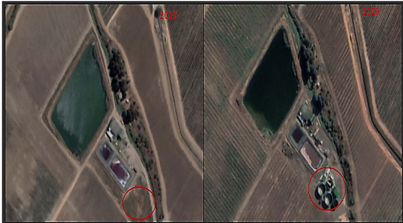
Figura 1. Imágenes satelitales Google Earth de la planta de tratamiento de RILes de Viña San Pedro Planta Molina. A la izquierda, se muestra imagen satelital del año 2019; A la derecha, imagen satelital del año 2020. Se puede apreciar la ampliación del sistema de tratamiento de RILes (en rojo), mediante la implementación de un sistema de tratamiento biológico en la unidad fiscalizable.
