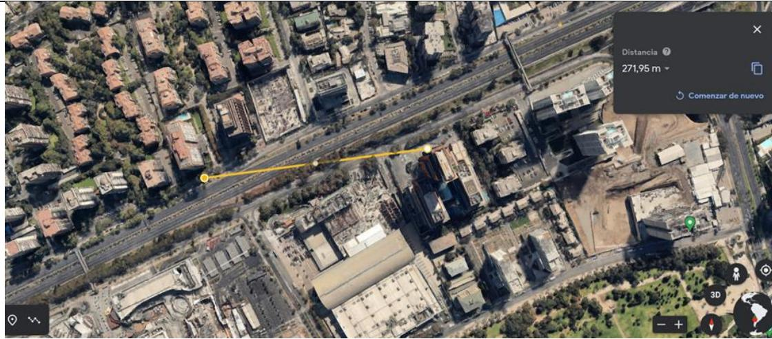
Si el receptor denunciante se ubica a 270 metros aproximadamente, el modelo entrega un nivel de 52 dB(A), para Zona UC2 del Plano Regulador de Las Condes, homologable a Zona III con 50 dB(A) de límite.
