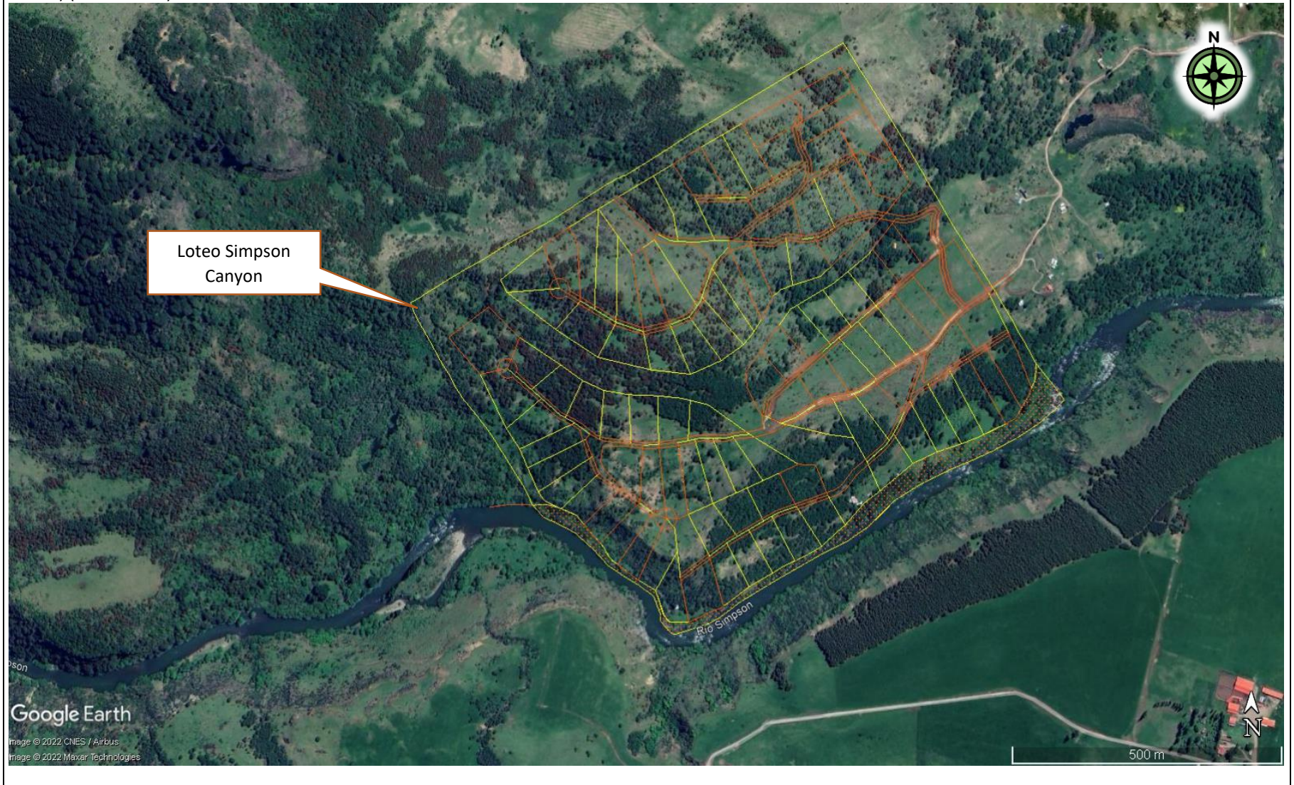
Figura 2. Mapa de Layout del proyecto correspondiente a 106 lotes de 0,5 Ha como área mínima y 12,26 Ha de área común (Fuente: KMZ ingresado a la SMA por el Titular) (Ver anexo 4)
