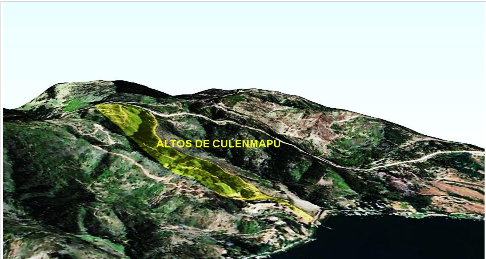
Figura 13. Imagen 3D. Polígono de la unidad fiscalizable sobre imagen satelital ESRI con modelo de elevación elaborado en base a mapa curvas de nivel del sector donde se emplaza la unidad fiscalizable.
