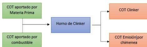
Para realizar la segregación del aporte de la emisión de COT correspondiente a los materiales empleados como materia prima y como combustibles, se utilizaron como base de cálculo las cantidades de Alimentación (material que ingresa al Horno), Petcoke (combustible tradicional) y combustible de sustitución sólido (CSS) utilizados durante el año productivo 2021. La siguiente tabla consolida lo indicado:
