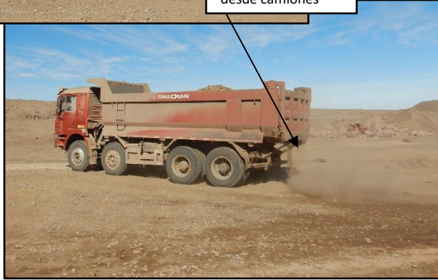
Caída de carga desde camiones
