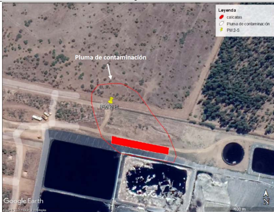
Imagen 12: Ubicación del pozo de monitoreo PM2-S y el sector de calicatas donde se registró la infiltración informada en el Incidente N°2-2021. El polígono rojo muestra la posible ubicación de la pluma de contaminación detectada.
