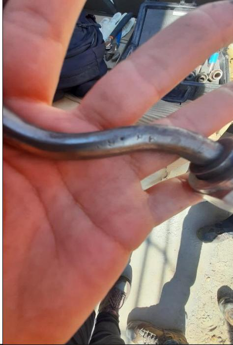
**Fotografía N° 4:** Actividad de inspección 03-05-2022. Boquilla de sonda sucia.
