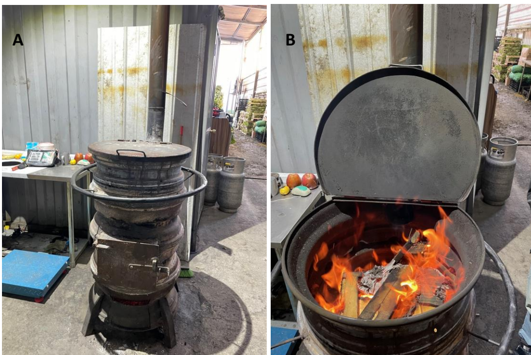
Imagen 2: Artefacto a leña funcionando al interior de dependencias de Frutería El Macutito: (A), Vista del artefacto; (B), Interior del artefacto en combustión de madera y carbón.
