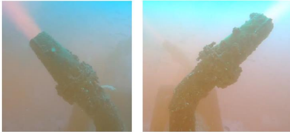
Imagen 18 Rodamina WT25 saliendo por Difusores número 4 y 3
