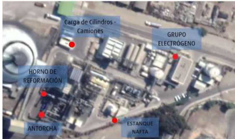
Figura 3. Mapa con ubicación Fuentes Emisoras de la Unidad Fiscalizable (Fuente: Punto 6. Plano Operacional LINDE -Versión 2).
