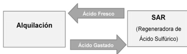
Figura 4: Esquema Unidad de Regeneración de Ácido y Alquilación
