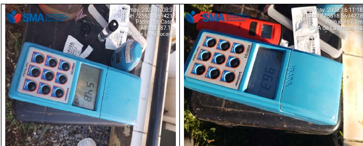
Fotografía N°7 y 8: Mediciones realizadas “in situ” de turbiedad en efluente tratado de la PTAS San Ramón para las descargas de Módulos 1 y 2 respectivamente
