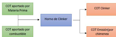
*Para realizar la segregación del aporteante de la emisión de COT correspondiente a los materiales empleados como materia prima y como combustibles, se utilizaron como base de cálculo las cantidades de Alimentación (material que ingresa al Horno), Petcoke (combustible tradicional) y combustible Alternativo Sólido (CAS) y Combustible Alternativo Líquido (CAL) utilizados durante el año productivo 2022. La siguiente tabla consolida lo indicado:*
