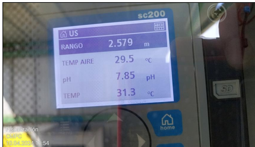
Fotografía 6. Panel de control de parámetros medidos en cámara previa a la descarga de RIL.
