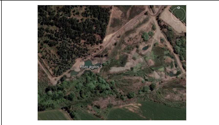
Figura N°8 Descripción del medio de prueba: Evidencia de imagen Google Earth del 25.04.2017 que muestra extracción de áridos en el Pozo N°3, con afloramiento de aguas subterráneas.
