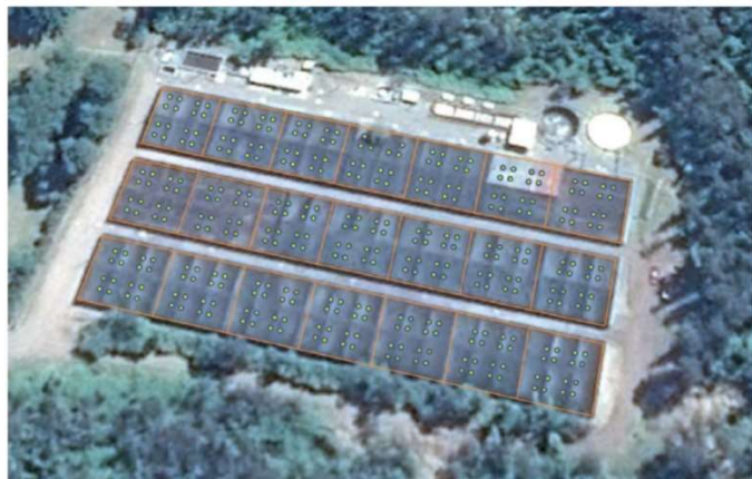
Imagen 4.- Diagrama general de ubicación de aspersores en el Biofiltro de planta de tratamiento de riles Prolesur Los Lagos.
