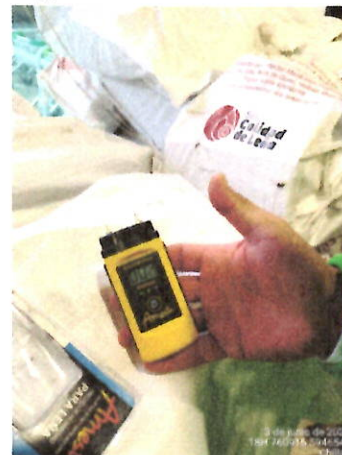
Fotografía 2: Xilohigrómetro en la unidad
