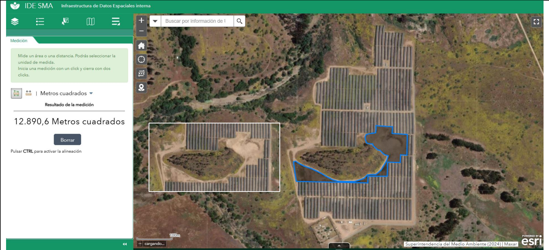
Figura 4 Fecha: Año 2024 Coordenadas UTM, WGS84, Huso 19 Norte: 6.391.474 m. Este: 278.353 m. Descripción medio de prueba: El polígono azul indica superficie de suelo de 5.137 m 2 que resultó afectada por trabajos de escarpes durante la etapa de construcción de la planta fotovoltaica San Marino Solar. En imagen de la izquierda se aprecia con más nitidez el área de suelo intervenida. Fuente: SMA.
