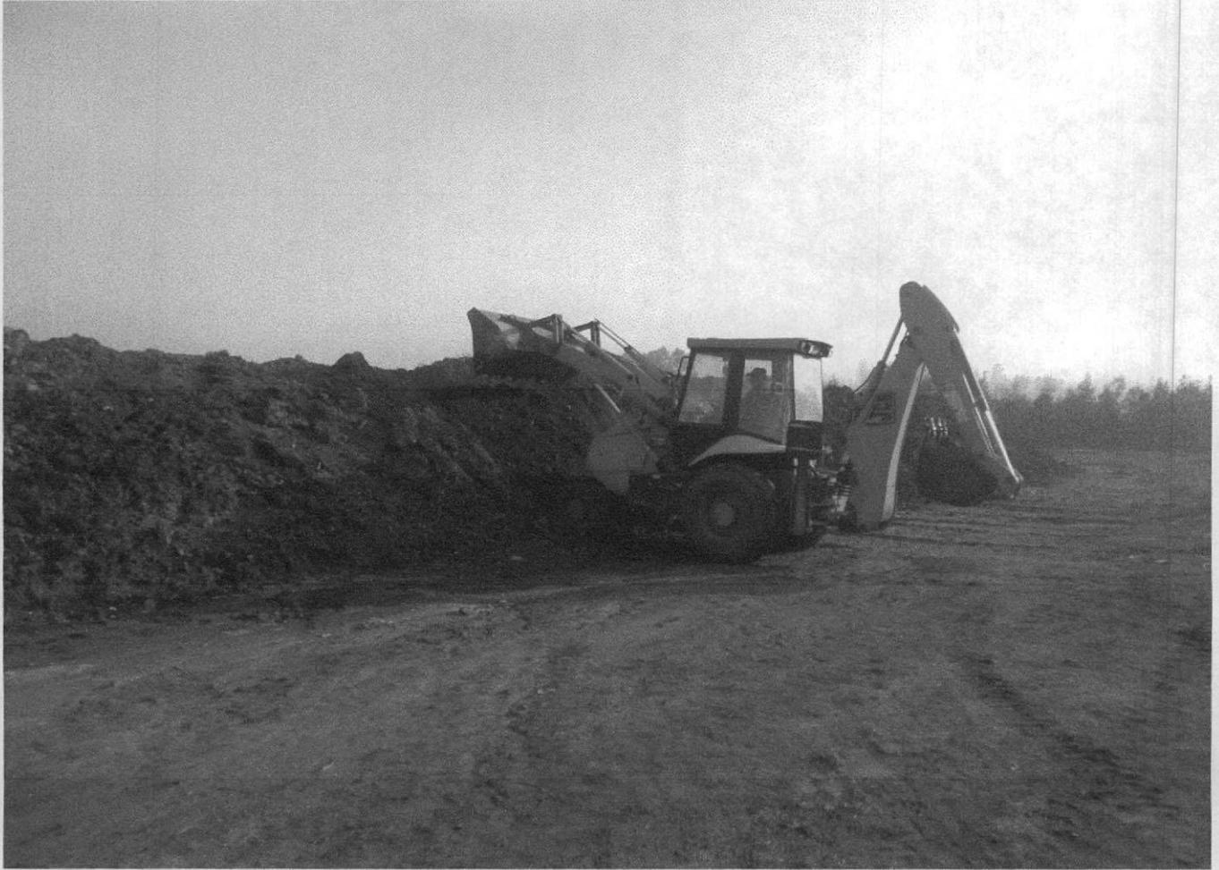
Ejemplo de pila en proceso de volteos
