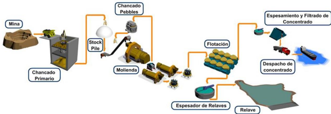
Lámina 4: Representación del proceso de producción de concentrado de cobre (Hipógeno)
