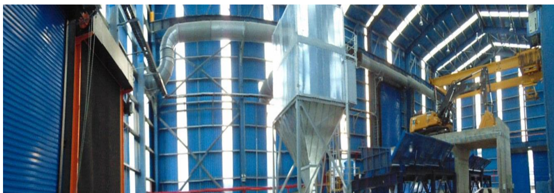
Imag. 3 Colector de Polvo tipo Filtro de Mangas
