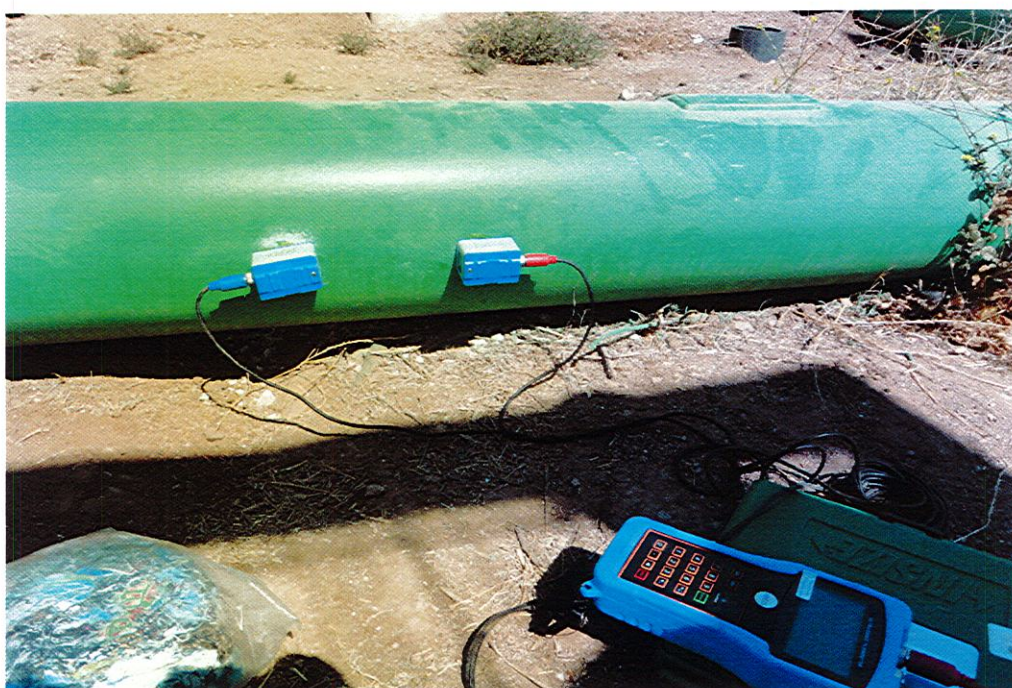
Foto 4: Medición con flujómetro portátil.
