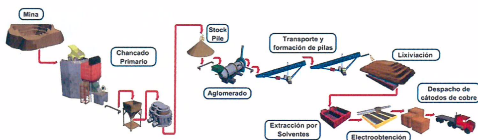
Lámina 3: Representación del proceso de producción de cátodos de cobre (Supérgeno)
