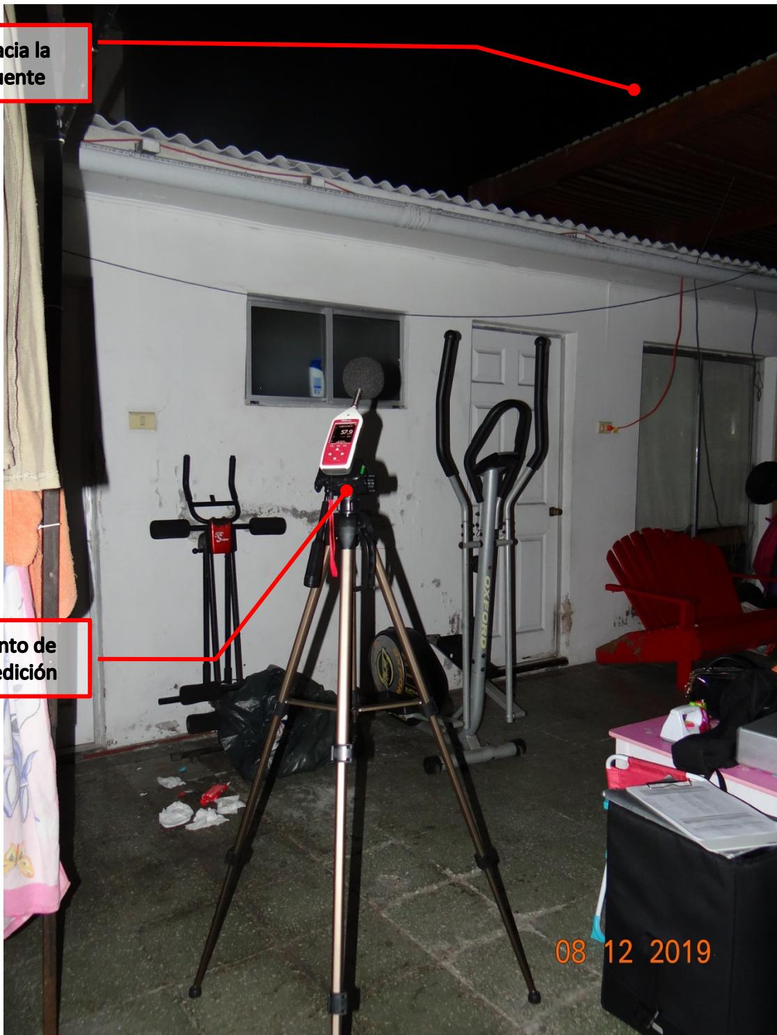
**Fotografía 1.****Fecha:** 08-12-2019.**Coordinadas UTM Datum WGS84 Huso 19S.****Norte:** 7.380.516**Este:** 355.919**Descripción Medio de Prueba:** Punto de medición en exterior (patio abierto), en receptor N° 1, expuesto a los ruidos generador por la fuente "Barú Lounge Bar".
