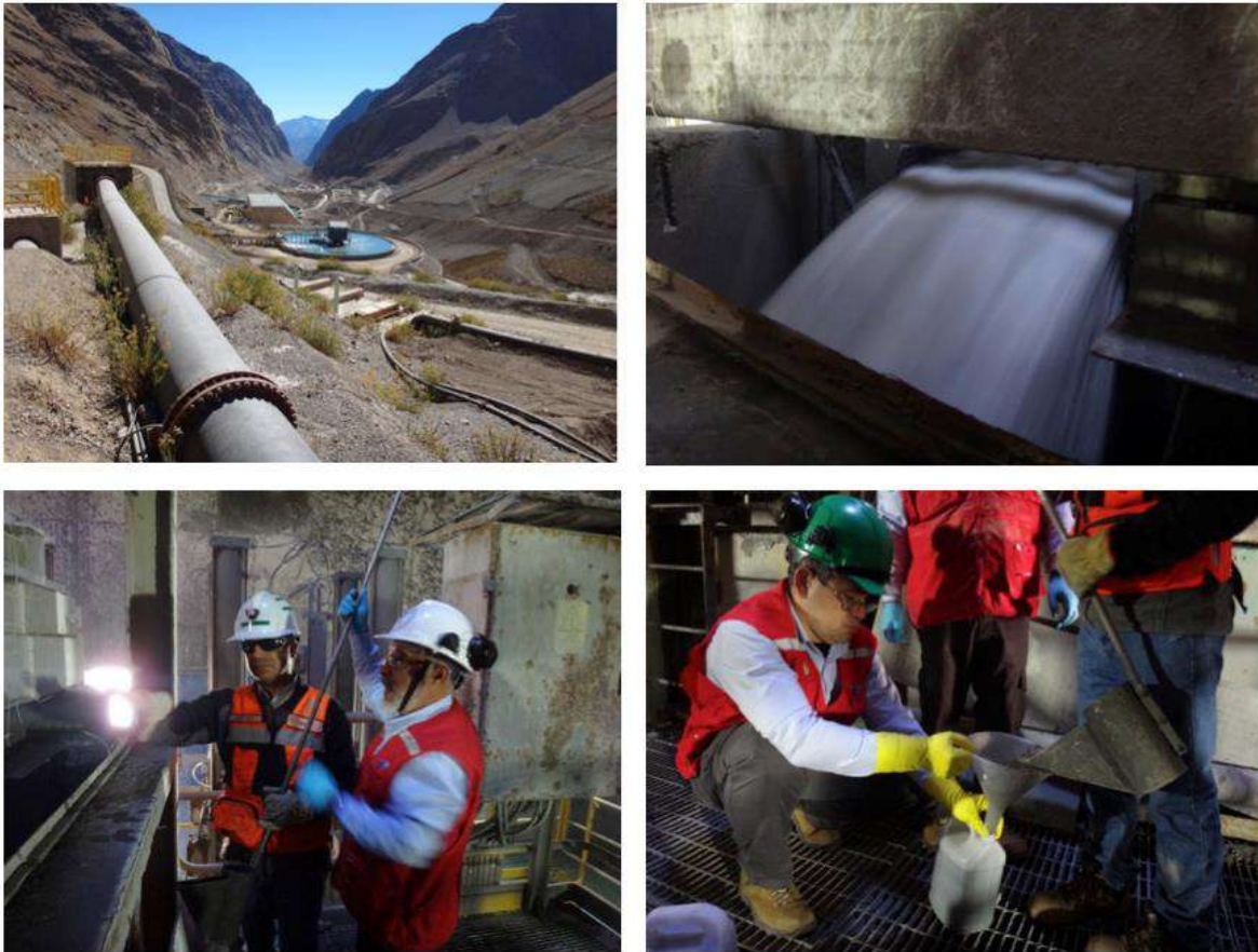
Figura 38. Actividades de muestreo del relave DAND para su caracterización y evaluación toxicológica, realizadas el 30 de enero del 2019.
