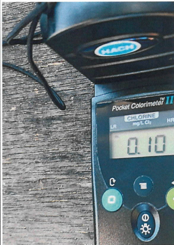
Foto 12 Medición directa en efluente cloro libre residual.
