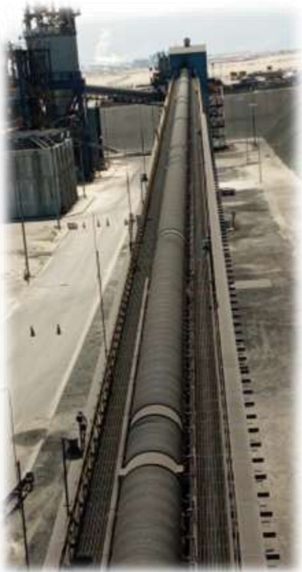
Foto 16: correas C-208 – C-215 cerradas con capotas.
