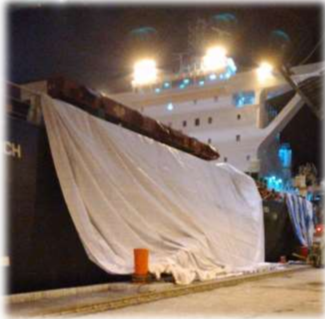
Foto 2: Manteletas para contener caída de graneles al mar
