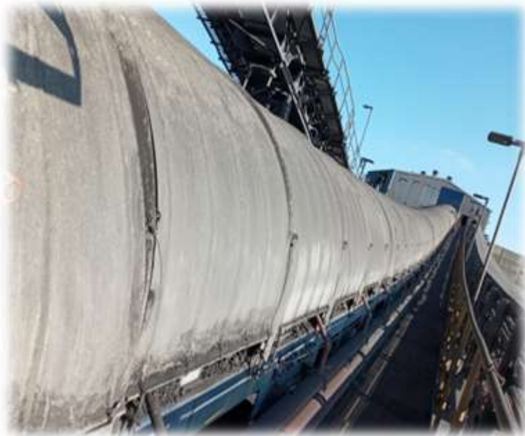
Foto 13: Correa C-202 cerrada con "capotas"
