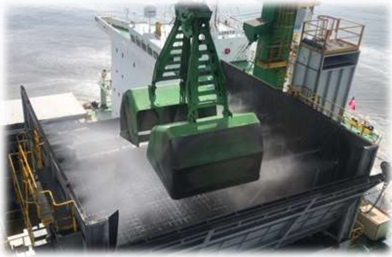
Foto 3: Supresores de polvo en tolva utilizados para descarga de carbón.
