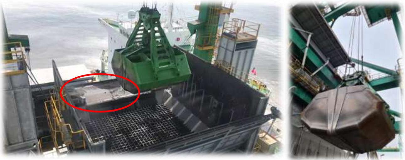
Foto 2: Manteletas para contener caída de graneles al mar
