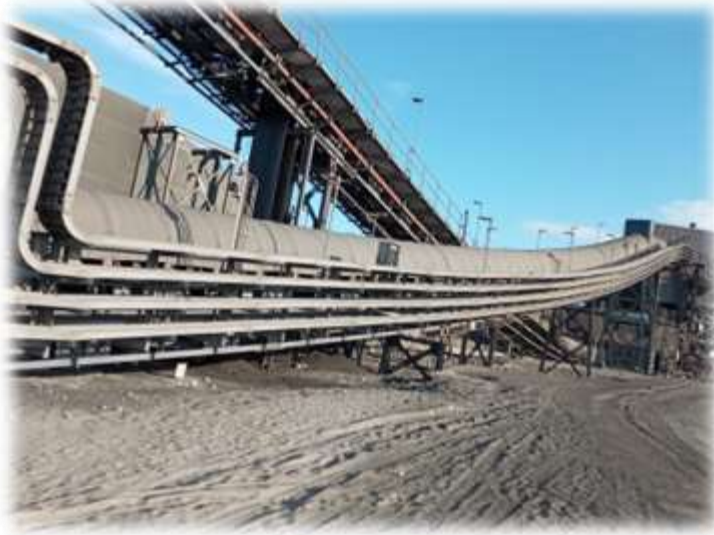
Foto 16: correas C-208 – C-215 cerradas con capotas.
