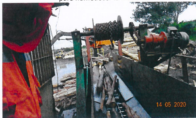
Fotografía 6. Línea de entrada al astillador con aspersores para humedecer la madera.
