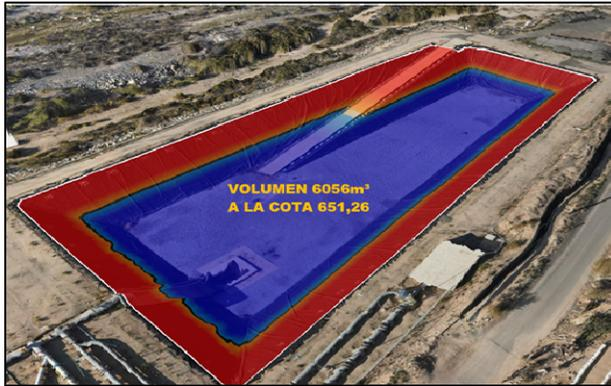
Con cota 651.21 se calculo un volumen de agua drenada de 6056m<sup>3</sup>. Con esto destacamos que de los 20639m<sup>3</sup> quedan disponibles 14583m<sup>3</sup> para llegar al 100% de la capacidad de la piscina.
