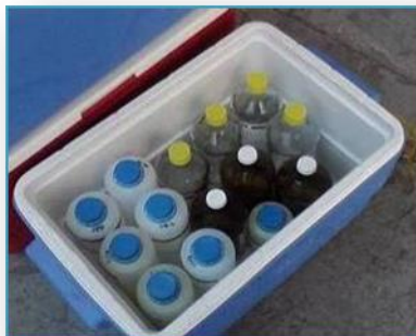
Figura N°4.4. Preservación- Refrigeración de Muestras
