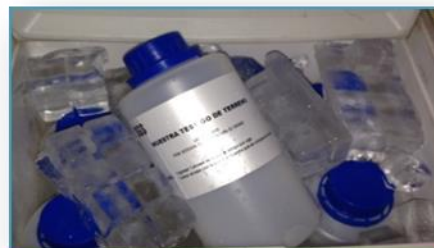
Figura N°4.4. Preservación- Refrigeración de Muestras
