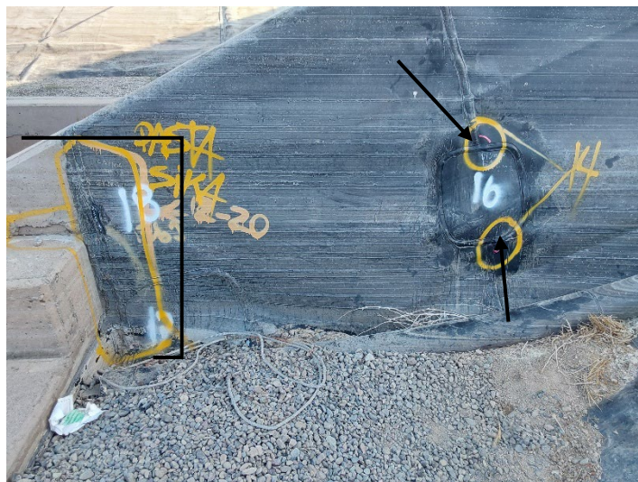
Fotografía 41: Fallas 14 en reparación anterior 16
