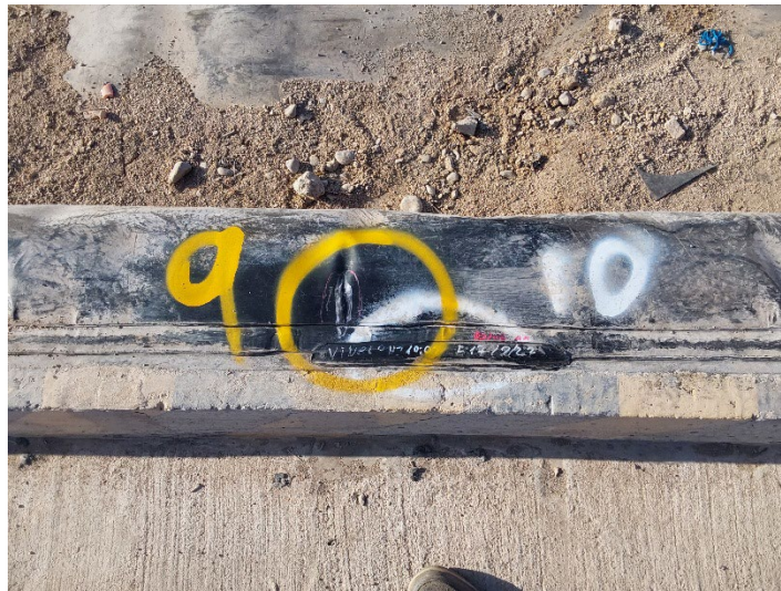
Fotografía 12: Reparación 10 aprobada, junto nueva falla 9
