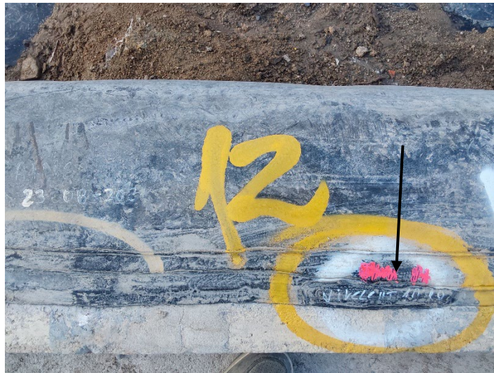
Fotografía 39: Falla 12 en reparación anterior 11
