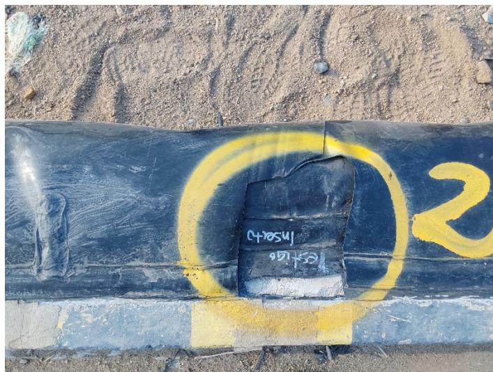
Fotografía 29: Nueva Falla 2, se toma muestra de inserto polimérico y aporte de extrusión
