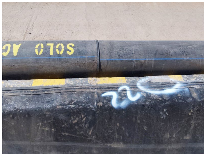
Fotografía 18: falla 22 rotura de inserto (mala reparación)
