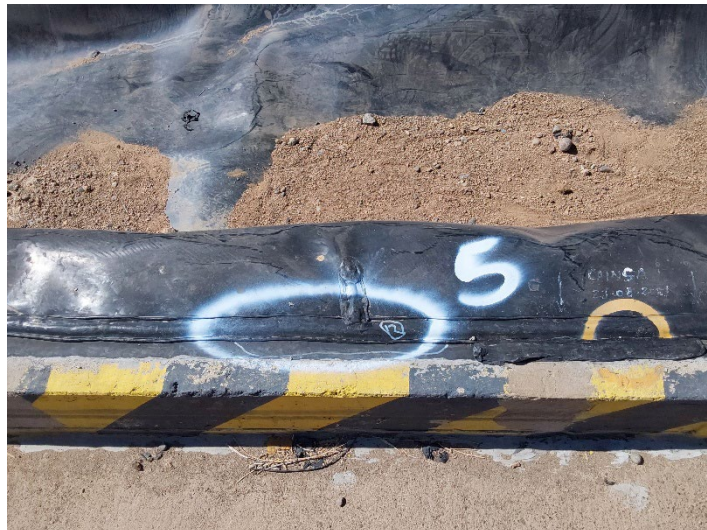
Fotografía 5: falla 5 rotura de inserto (antigua 12)
