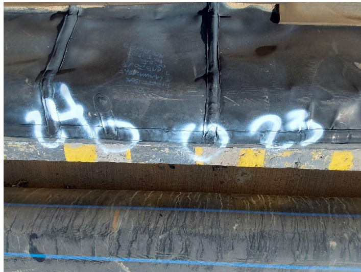
Fotografía 19: fallas 23 y 24 filtración de extrusiones
