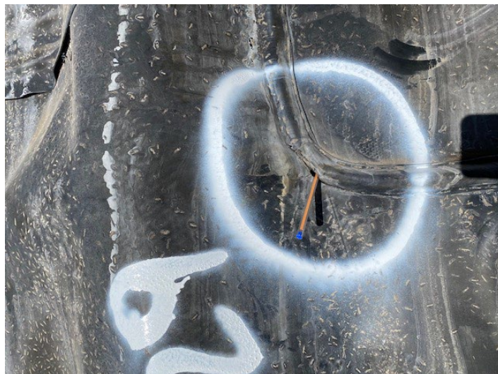
Fotografía 23: falla 26 rotura de geomembrana en perímetro de parche
