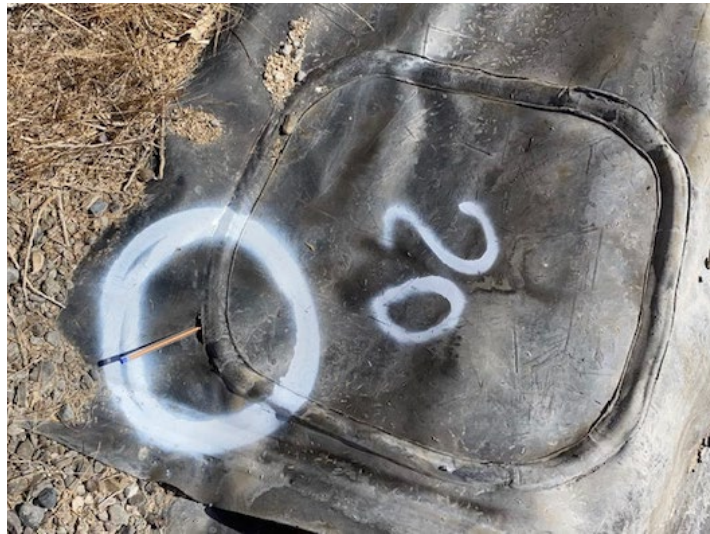
Fotografía 16: falla 20 rotura parche (estiramiento llenado de piscina)
