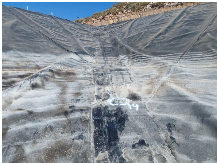
Fotografía 15: falla 19 rotura parche (estiramiento llenado de piscina)
