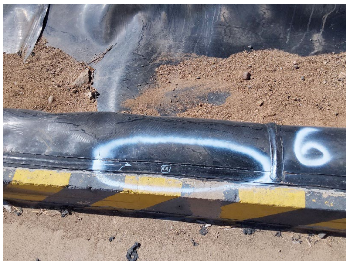
Fotografía 6: falla 6 rotura de inserto (antigua 11)
