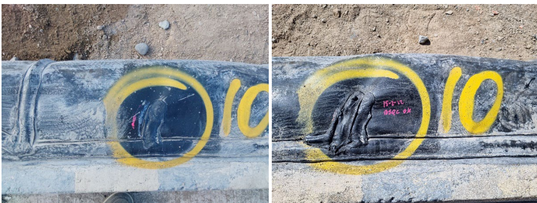
Fotografía 11: Reparación falla 10, antes y después
