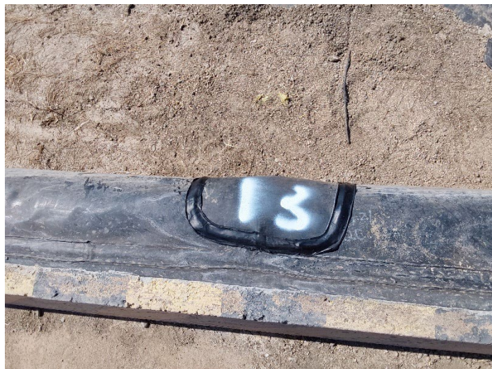
Fotografía 12: falla 13 rotura (golpe operación de llenado)
