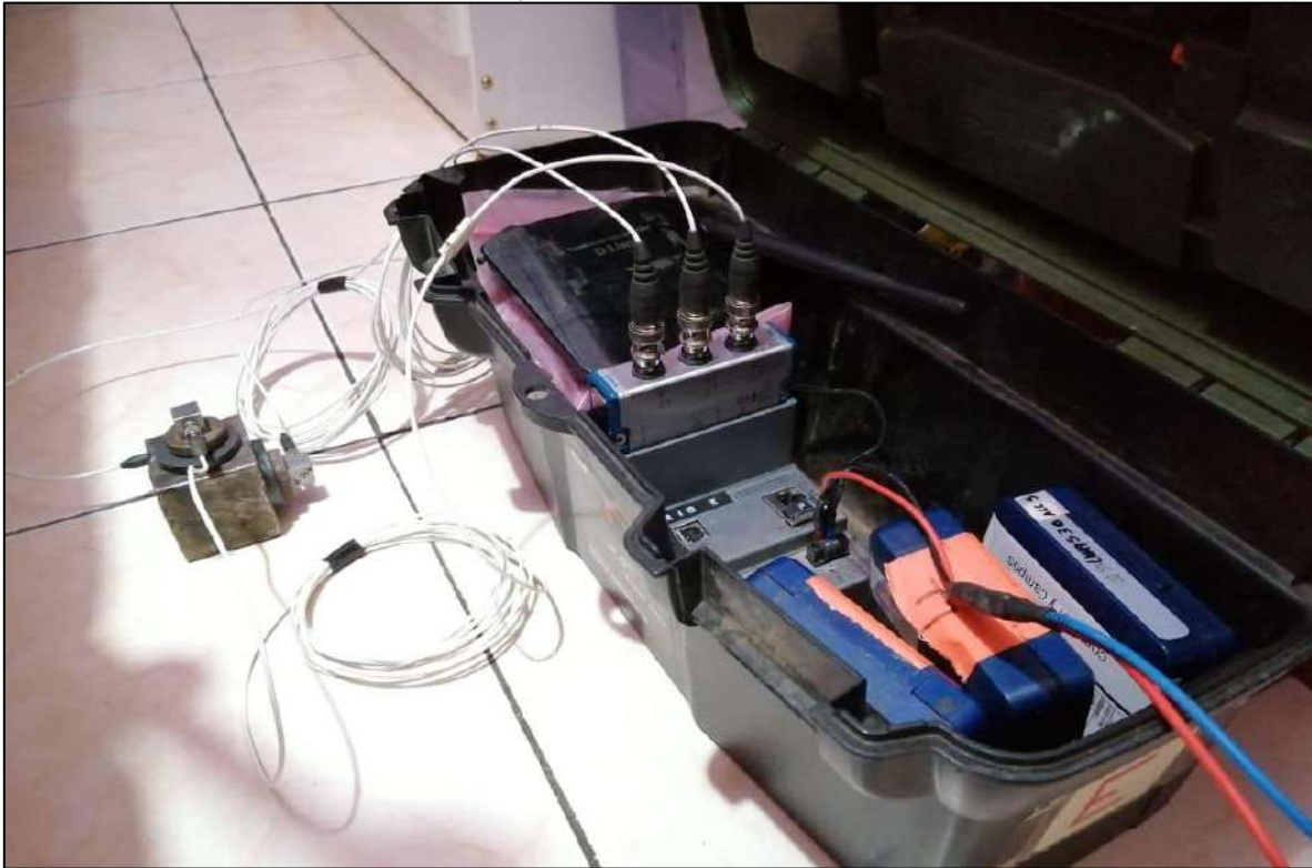
Ilustración 5. Montaje medición triaxial de velocidad de vibración.
