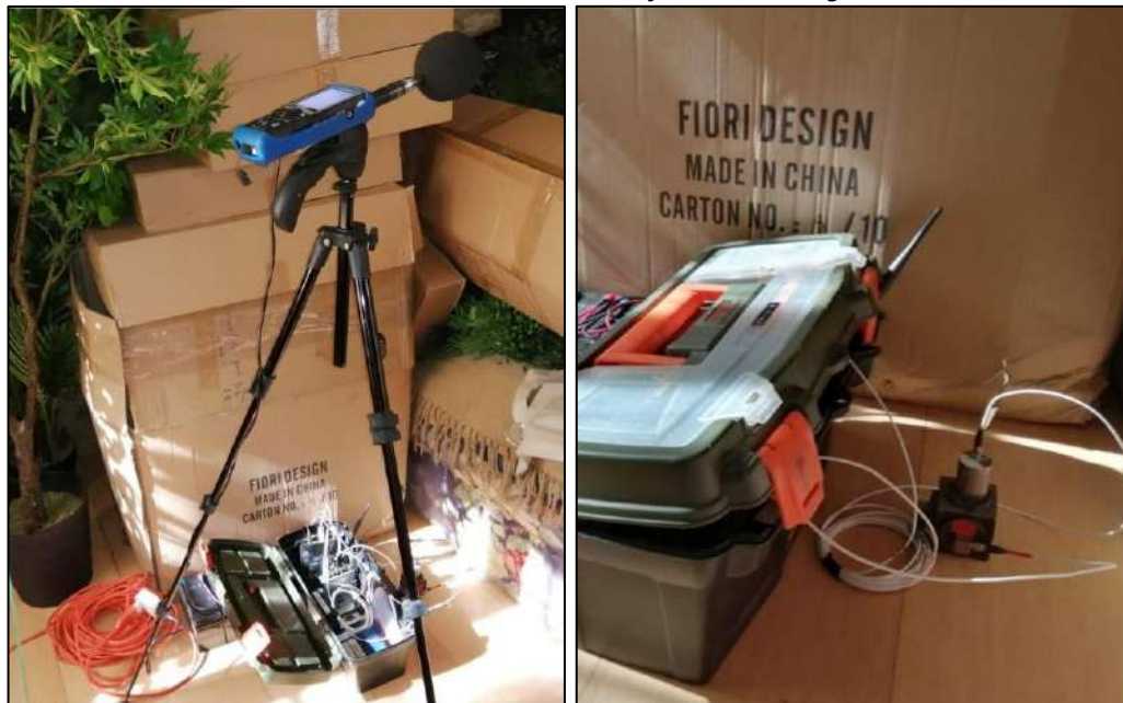
Ilustración 1. Medición simultánea de ruido y vibraciones, registro triaxial.
