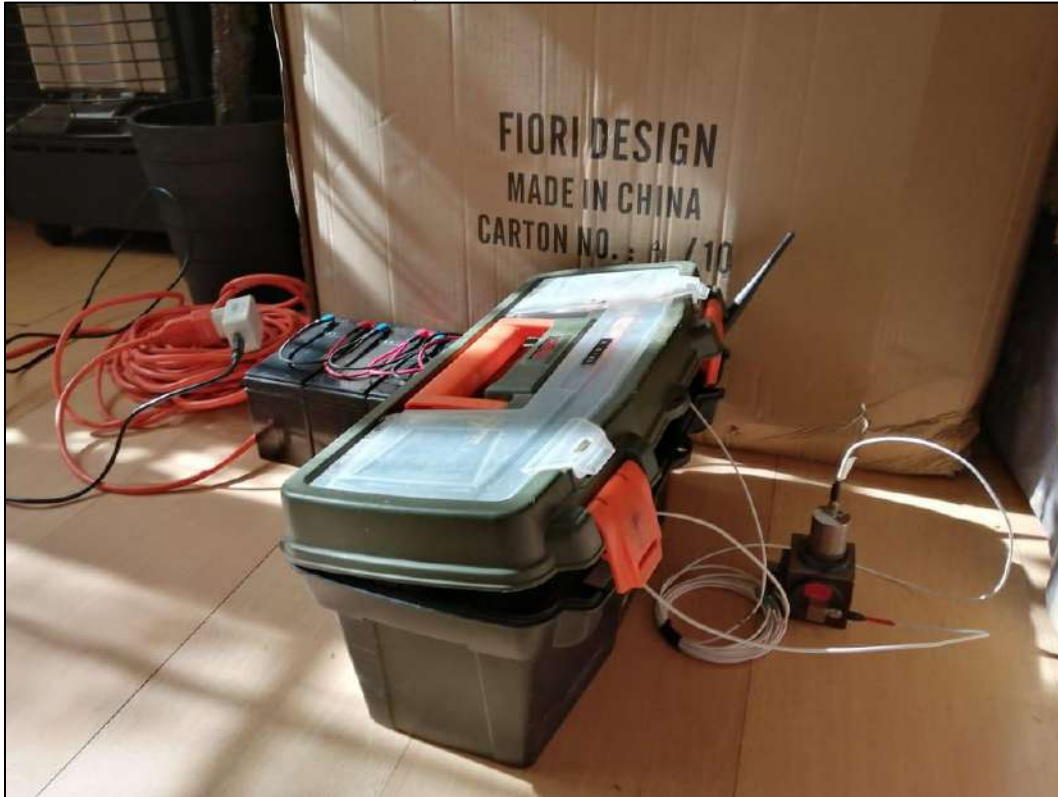
Ilustración 5. Montaje medición triaxial de velocidad de vibración.
