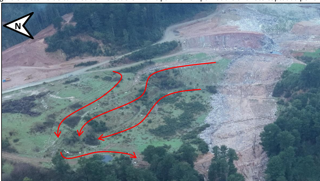
Figura 8. Sistema de canales del Vertedero Municipal Morrompulli sobre una foto captuada por dron.
