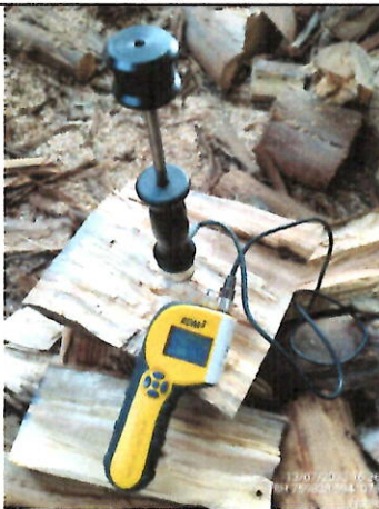
Registro fotográfico medición N°2 de humedad
