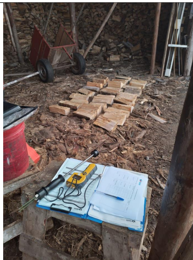
Fotografía N°2 Fecha: 17/05/2024 Descripción: Fotografía procedimiento monitoreo de humedad de leña.
