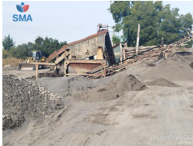
Separadora de arena en operación
