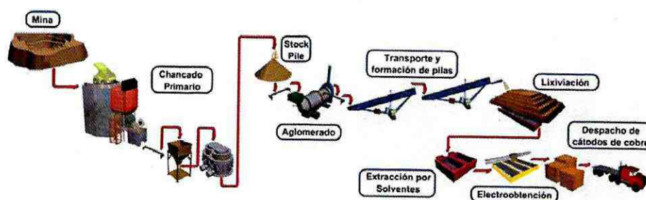
Lámina 3: Representación del proceso de producción de cátodos de cobre (Supérgeno)
